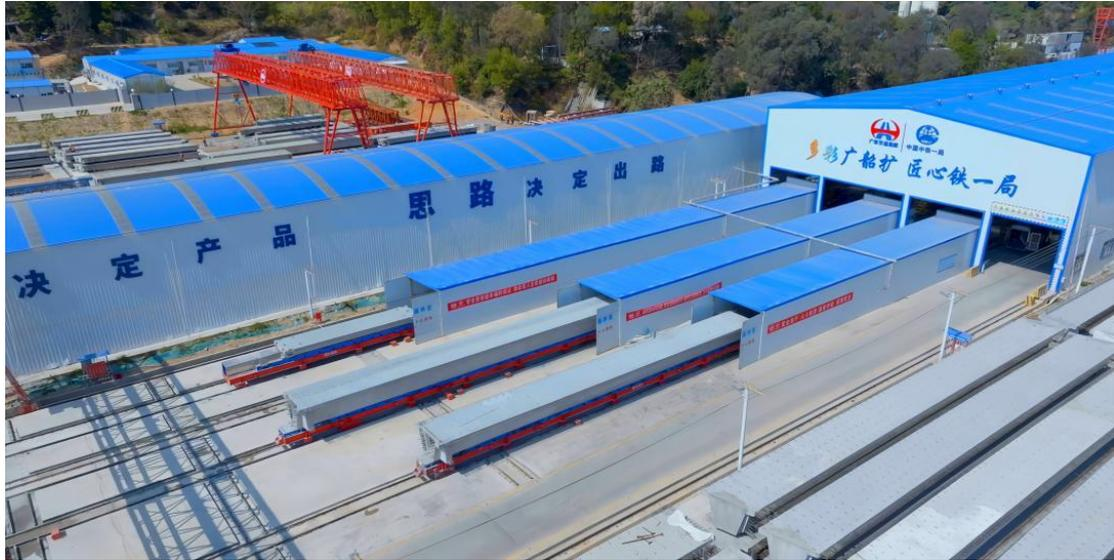
广韶高速改扩建项目（南段）通过推行“四全四法”质量管理体系，创新应用建设管理数字化管控一体化平台、智慧梁场成套技术、新泽西护栏自动生产线等 20 余项“四新”技术成果，同时广泛开展微创新活动，形成新泽西自动焊接机器人、玻璃钢临时排水设施等 30 余项微创新成果，持续探索高速公路智慧建造新模式。
