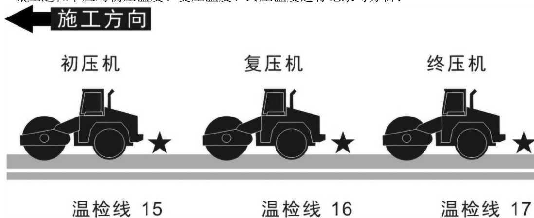
图B.11 碾压过程温度检测线位置
