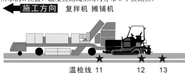
图B.9 摊铺过程温度检测线位置
